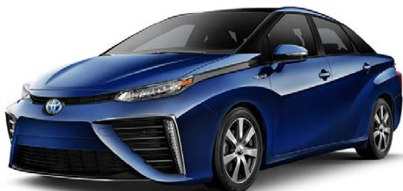
Toyota Mirai – världens första serietillverkade bränslecellsbil som lanserades under 2015 i Japan och Kalifornien.
