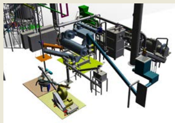
Slutmontage och driftsättning av testanläggningen i Köping om 500 kW syngaseffekt. På bilden ovan syns matningen av biomassa till torken samt hetgasaggregatet.
